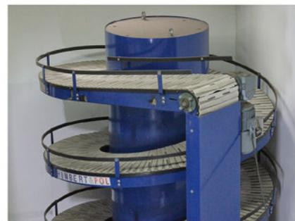
La superposition des lattes, notamment à la périphérie des spires, assurent autant la réduction des frottements des objets en mouvement qu'un fonctionnement fiable et silencieux du convoyeur.
